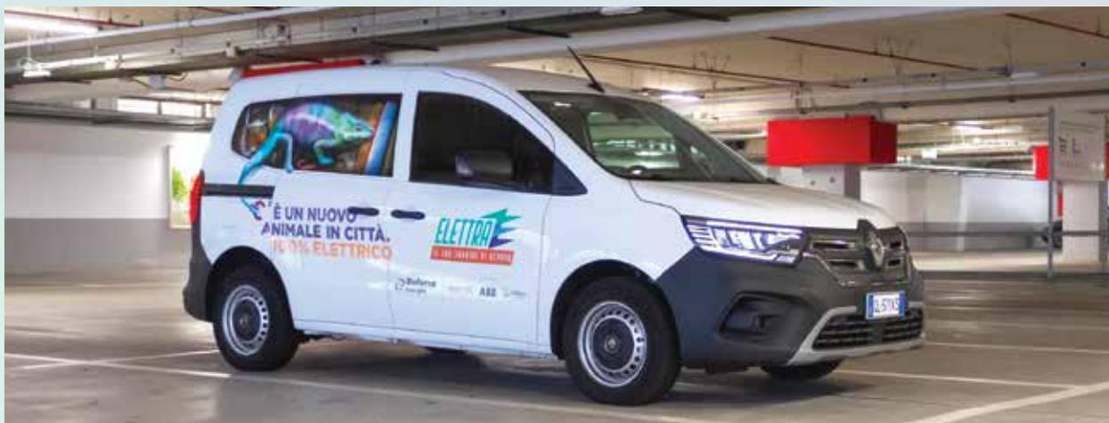
Il servizio Cargo dispone di veicoli Kangoo Van E-Tech 100% elettrici: furgoni compatti con un volume di carico di 3,3 metri cubi e alimentati da una batteria agli ioni di litio da 45 kWh che fornisce un'autonomia compresa tra i 250 e i 300 km.
